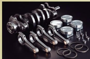
CustomKit EX 2.3L for 4B11 排気量 2,307cc ボア径 φ87 希望小売価格 ストローク 97mm (税別) 500,000 円 圧縮比 8.8 : 1 (GKt=0.8mm) (10%税込) 550,000 円
