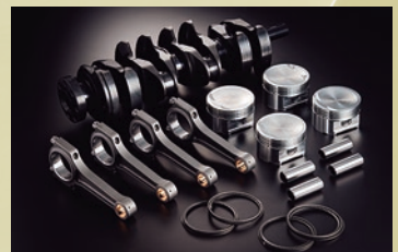
CustomKit EX 2.2L for 4B11 排気量 2,188cc ボア径 φ87 希望小売価格 ストローク 92mm (税別) 580,000 円 圧縮比 8.8 : 1 (GKt=0.8mm) (10%税込) 638,000 円
