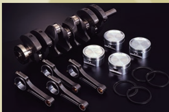
CustomKit EX 2.2L for 3S-GTE 排気量 2,188cc ボア径 φ87 希望小売価格 ストローク 92mm (税別) 640,000 円 圧縮比 8.3 : 1 (GKt=1.2mm) (10%税込) 704,000 円
