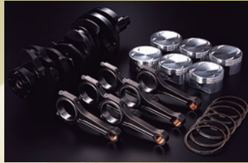
CustomKit EX trubo 3.8L for VQ35DE 排気量 3,772cc ボア径 φ95.7 希望小売価格 ストローク 87.4mm (税別) 1,100,000 円 圧縮比 8.4 : 1 (GKt=0.7mm) (10%税込) 1,210,000 円
